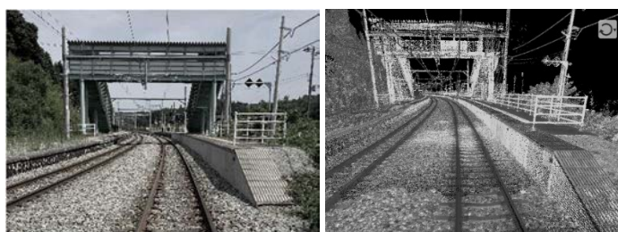
図-3 地上測定実施箇所 (左:写真, 右:点群)
