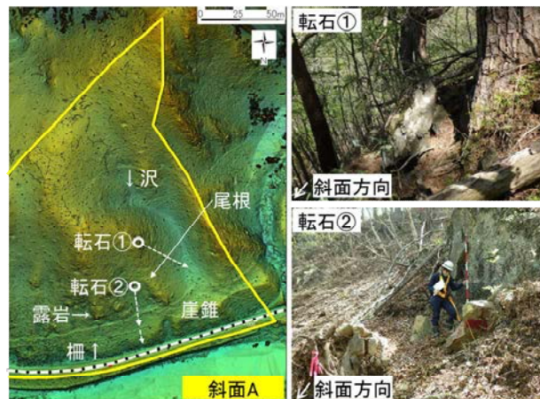
図6 斜面Aの微地形3Dモデル(左)と転石①②(右)
