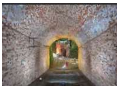
図6 トンネル点群データ図
