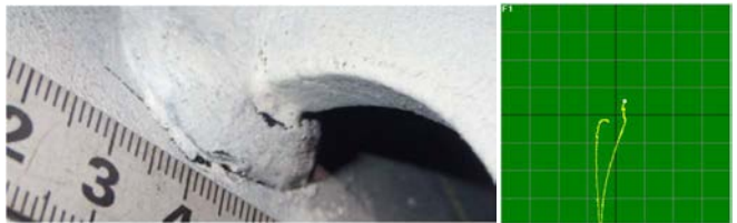
図-4 検出できた3mmの母材進展き裂と波形信号
