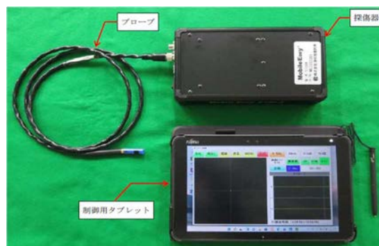
図-1 探傷器 (mobile eddy)
