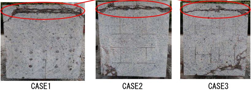
写真-1 試験体中央部の切断面写真
