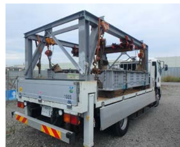
写真-2 9 t 軌陸平トラックによる運搬
