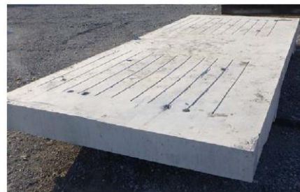
写真 1 引抜き後の供試体【CASE03】
