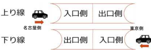
図-2 「入口側」「出口側」の考え方
