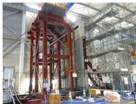
写真-1 覆工切削工の実証実験
