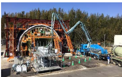
写真-4 模擬トンネル打設実験
