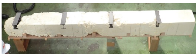
図6 片押し条件でのウレタン注入後の状況写真
