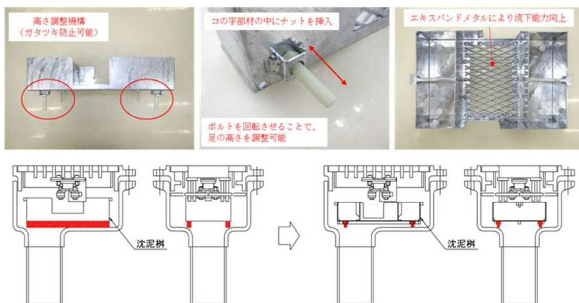
図-2 沈泥柵の構造改良事例
