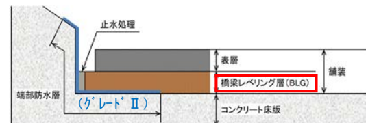
図-5 BLG 舗装構成（断面図）
