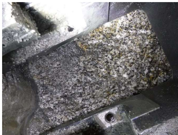
写真-2 全般に新鮮な岩盤面(169m 付近)
