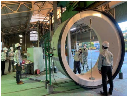
写真-1 外圧強さ試験状況
