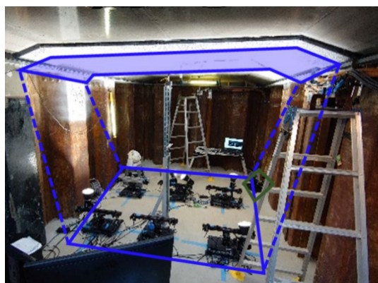
Photo 1 地下空間での画像相関法計測 カメラのセットアップ
