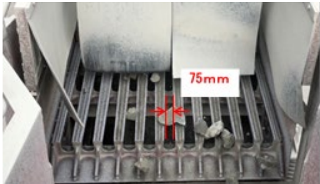
写真 2. デッキスクリーン開口幅
