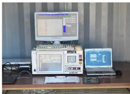
写真-2 自動グラウチングシステム（左よりプラント管理室、孔口管理ユニット、注入ユニット）
