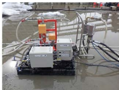
写真-2 自動グラウチングシステム（左よりプラント管理室、孔口管理ユニット、注入ユニット）
