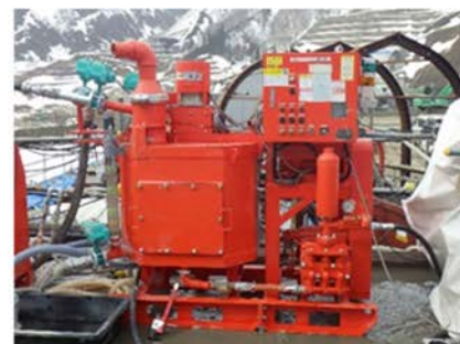
写真-2 自動グラウチングシステム（左よりプラント管理室、孔口管理ユニット、注入ユニット）
