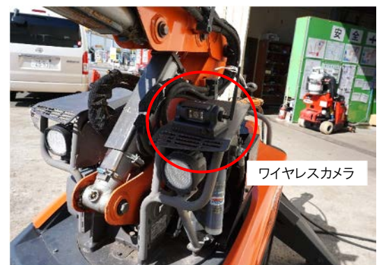
写真-5 ワイヤレスカメラ取付け状況
