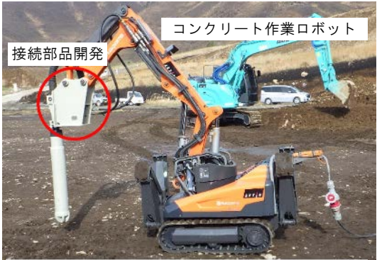
写真-1 コンクリート作業ロボット
