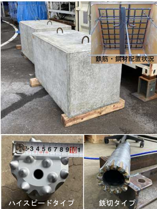
写真-2 コンクリート供試体、使用ビット
