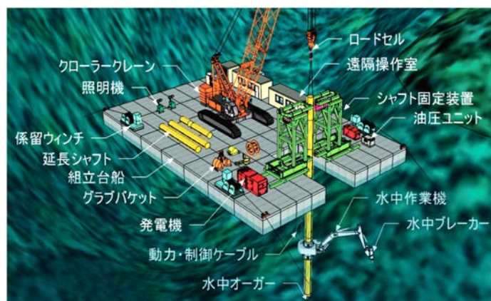
図-1 T-iROBO UW 概要図
