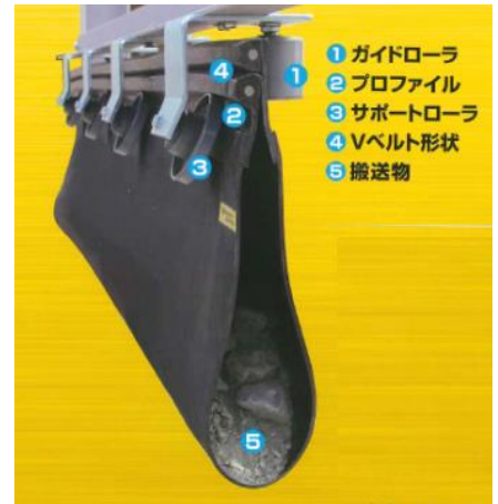
図-1 密閉式吊下げ型コンベヤ
