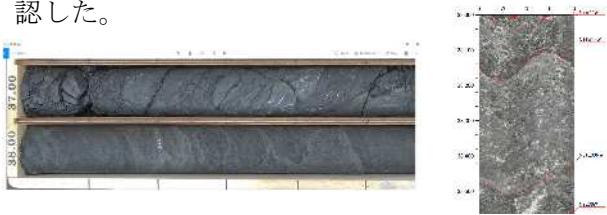
図-3 高品質ボーリング(左) ボアホールカメラ(右)
