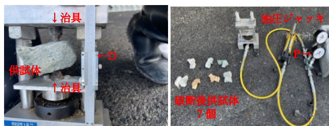
写真-2 供試体載荷状況(NO.53+27) 写真-3 破断状況(NO.53+27)
