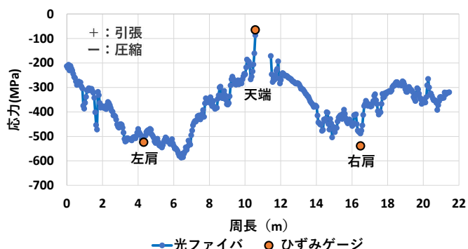
図-3 上半鋼製支保工の応力分布
