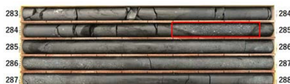
写真-1 コア写真(泥岩)
