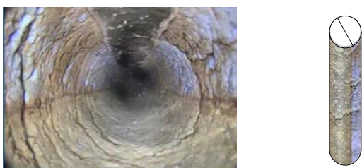
写真-2 孔内カメラとバーチャルコアの例
