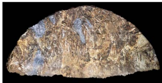
写真-1 切羽写真の亀裂の例
