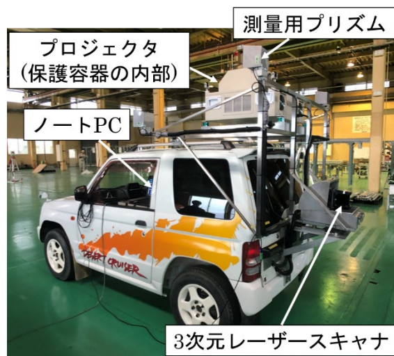
図1 切羽版 SP-MAPS の機器構成
