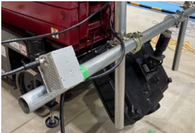
写真-3 LiDAR 取付状況
