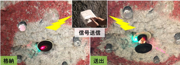
図-3 遠隔操作状況
