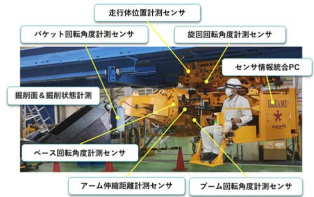
写真-1 天井走行式掘削機制御センサ
