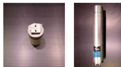
(a) セシウム線源 (b) 検知器 写真-2 RI 密度計
