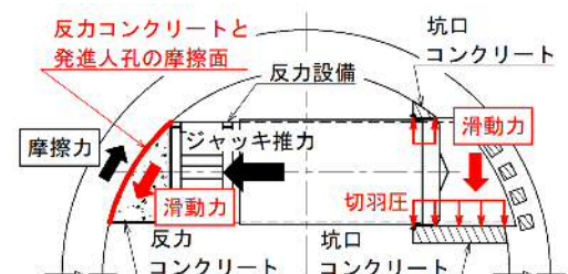
図-2 坑口、反力コンクリート滑動
