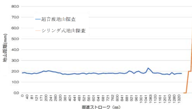
図-5 地山探査装置計測結果（840R）
