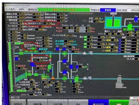
図-4 地山探査装置（超音波式）の管理画面
