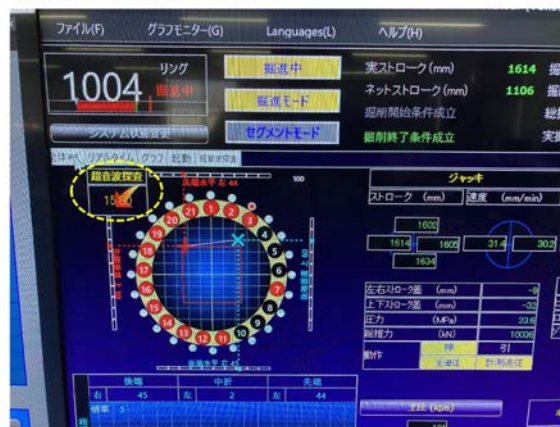
図-4 地山探査装置（超音波式）の管理画面
