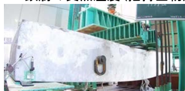
写真-2 載荷試験状況
