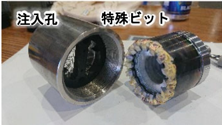
写真-1：注入孔と特殊ビット
