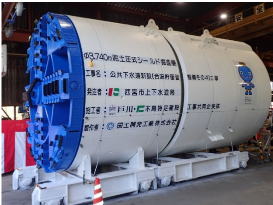
写真-1 シールドマシン全景
