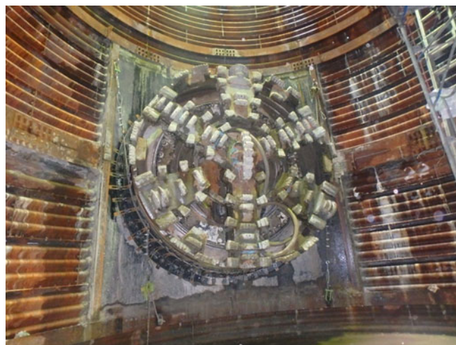
図-3 到達時カッタービット
