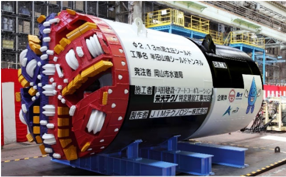
写真-1 シールドマシン
