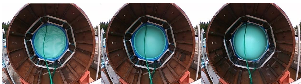
(a) 注水開始時(0秒後) (b) 背圧上昇開始(1,030秒後) (c) 背圧 0.20 MPa 作用(1,350秒後) 写真-1 実験状況
