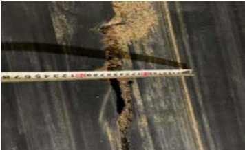
写真-3：検出したベルト損傷の例
