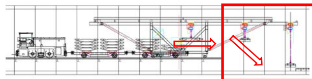
吊上げ後、方杖をかわした位置でインバートを回転
