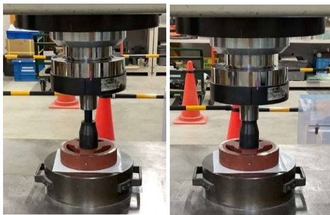
写真-2 単体挿入試験
