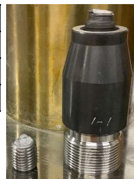
写真-3 引張試験終了後の試験体状況
