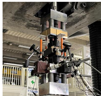
写真-3 単体引張試験状況
