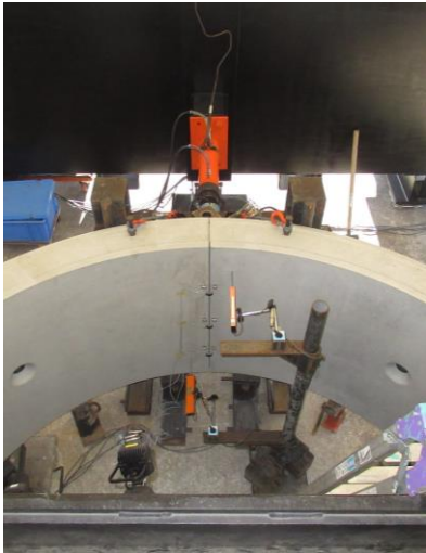
写真-5 継手曲げ試験状況
