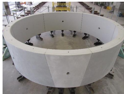
写真-2 リング組立試験状況（M サイズ）
