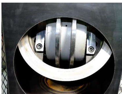
写真-2 ローラー回転交換時
