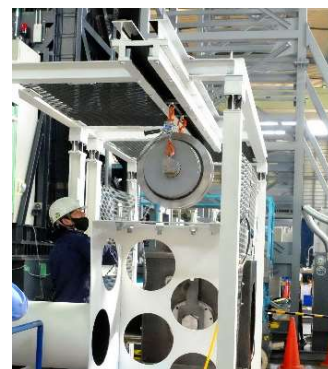
写真-3 ローラー吊上げ搬送時
