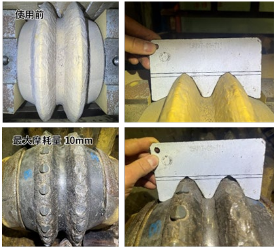
写真-3 3回目ローラカッタ摩耗状況
