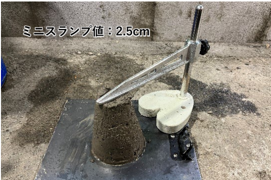
写真-5 ミニスランプ試験実施状況
