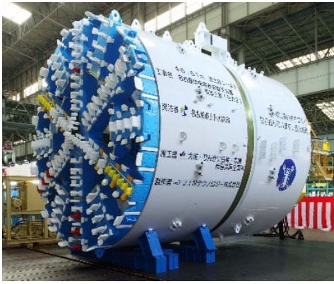
写真-1 シールド機全景
