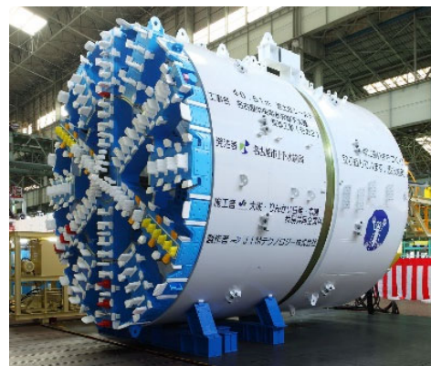
写真-1 シールド機全景
