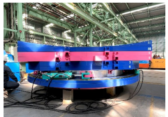
写-1 回転装置作動試験状況
